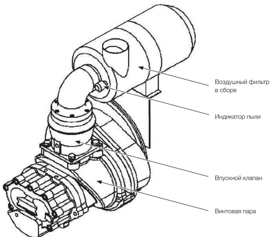
Рис. 4.3 Система воздухозабора
