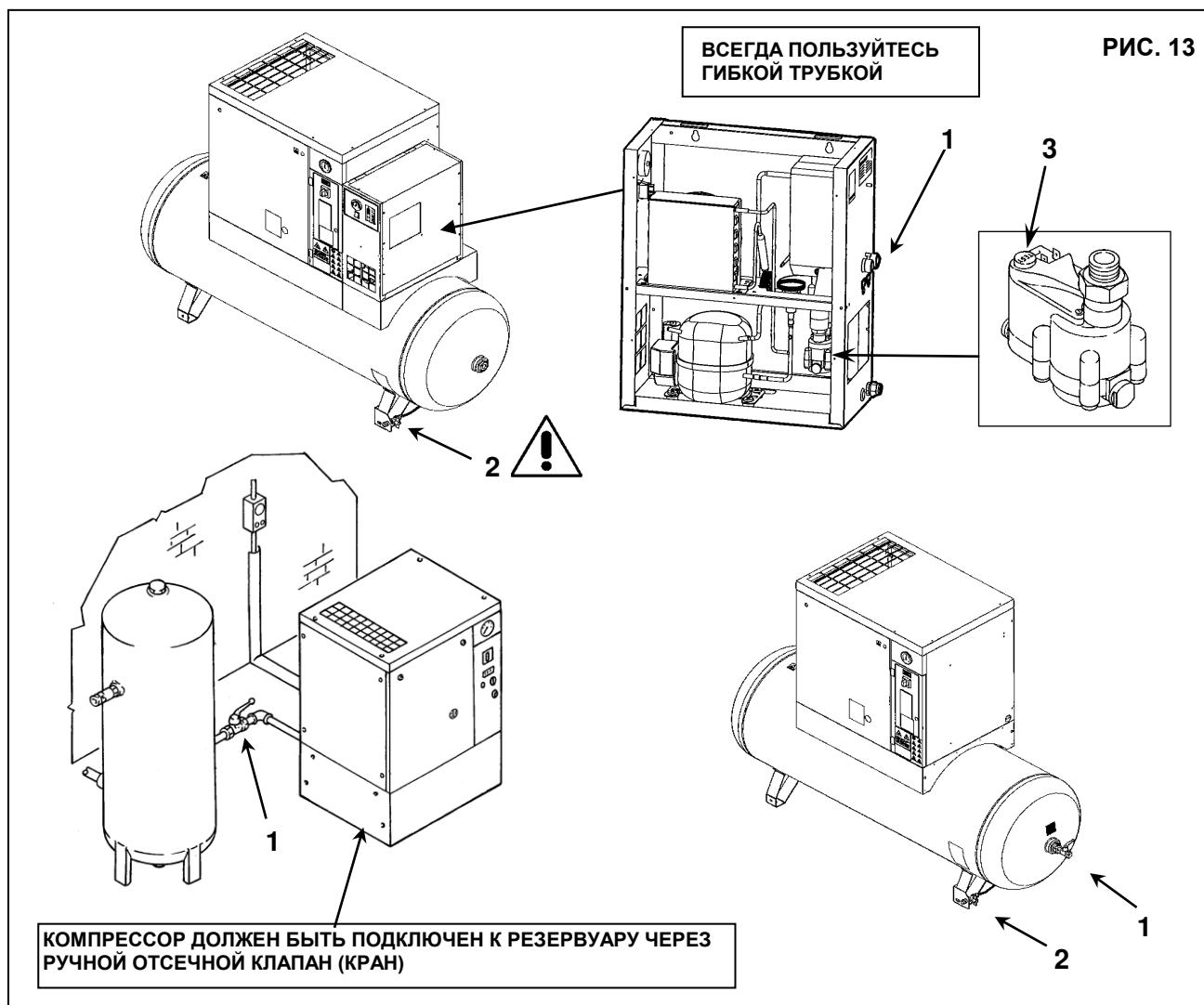
Ручной слив конденсата (поз. 2, Рис. 13) и автоматический слив конденсата (поз. 3, Рис. 13) проведены снаружи машины гибкими трубками, которые можно проверить. Слив должен соответствовать местным действующим нормативным актам.
