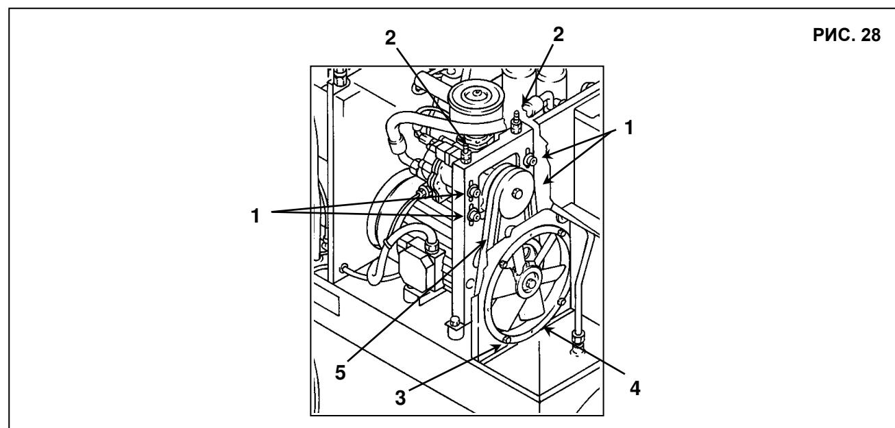
1 - F = 5 кг., усилие, которое следует прилагать к новому ремню по осевой линии под прямыми углами.
