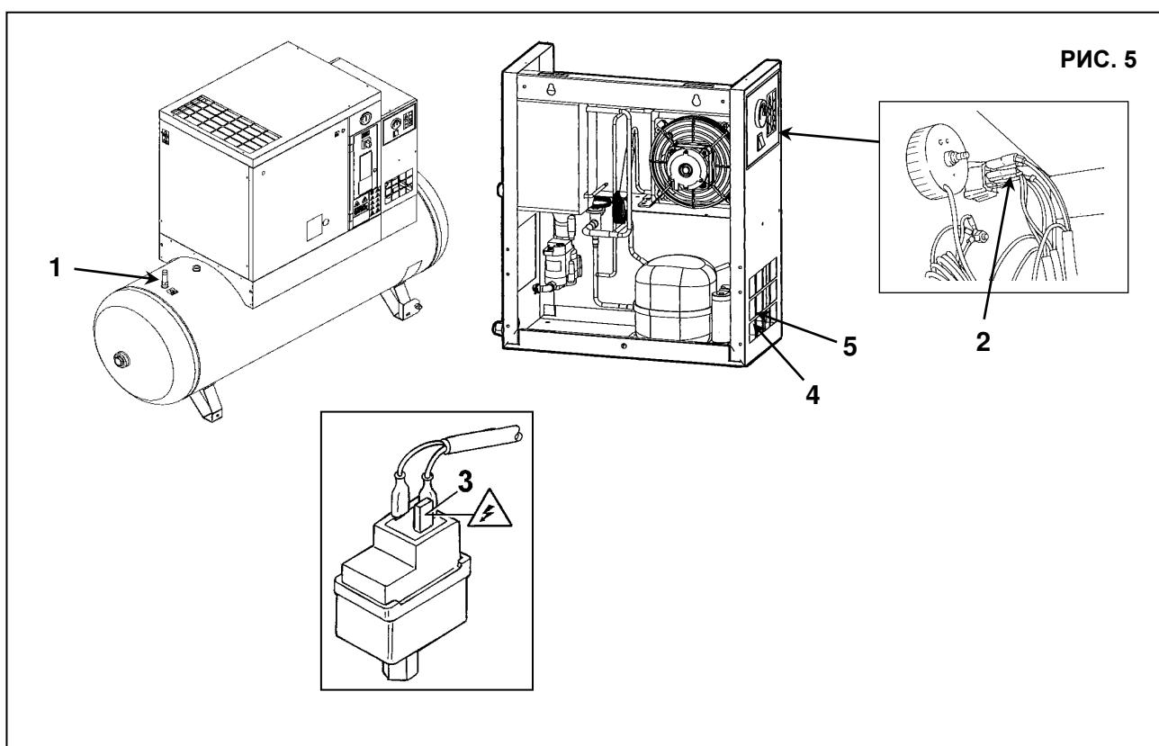
**8.0 РАСПОЛОЖЕНИЕ ТАБЛИЧЕК****8.1 РАСПОЛОЖЕНИЕ ПРЕДУПРЕЖДАЮЩИХ ТАБЛИЧЕК НА КОМПРЕССОРНОМ БЛОКЕ**
