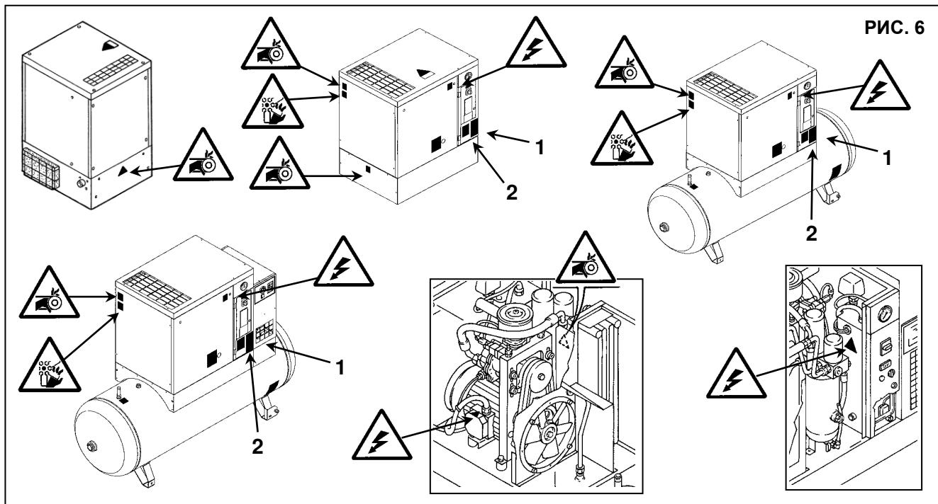
**8.2 РАСПОЛОЖЕНИЕ ПРЕДУПРЕЖДАЮЩИХ ТАБЛИЧЕК НА БЛОКЕ ОСУШИТЕЛЯ И РЕЗЕРВУАРЕ**
